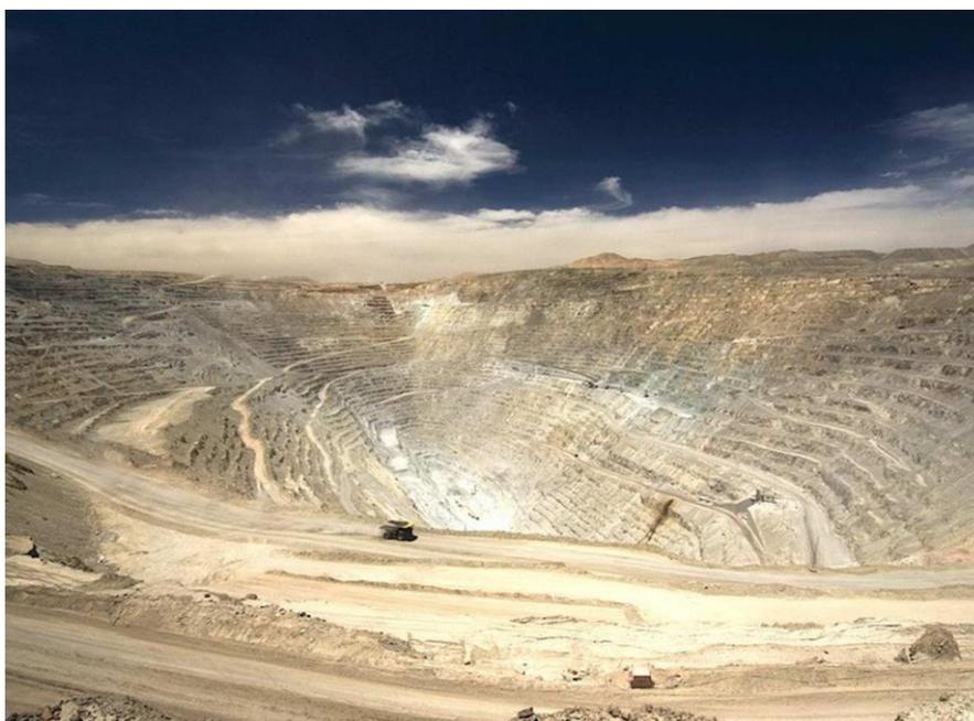
Fig. N° 09: Método de explotación a cielo abierto.
